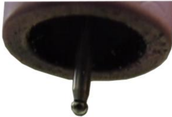
Rys. 44 Elektroda nietopliwa po procesie zaokrąglania
